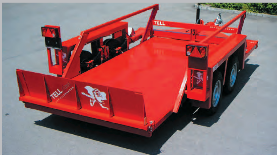
Les composants de la batterie et les composants hydrauliques sont intégrés dans le châssis et se ferment à clé.
