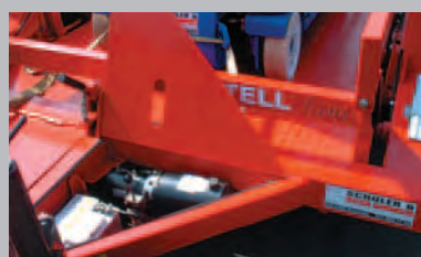
Les composants de la batterie et les composants hydrauliques sont intégrés dans le châssis et se ferment à clé.
