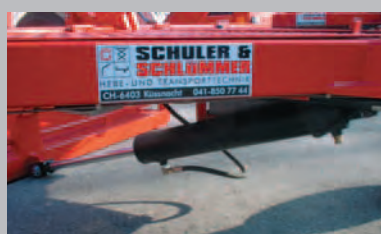
Le vérin de levage est protégé sous le timon et agit directement sur la plate-forme.
