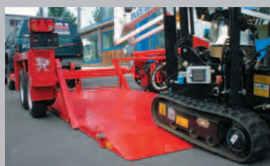
L'ensemble de la largeur de la plate-forme remplace la rampe, c.-à-d. que la faible inclinaison de la plate-forme permet également de charger des appareils reposant quasiment sur le sol.
