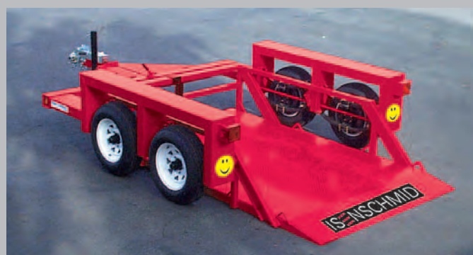
Rampe rabattable faisant office de protection
