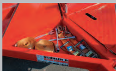
Espace de rangement intégré dans le châssis et pouvant être fermé à clé.
